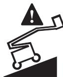
機械が水平でない場合にランプが点灯します。このランプが点灯している間、傾斜アラームが鳴ります。機械を安定した平坦な地面に移動してください。
