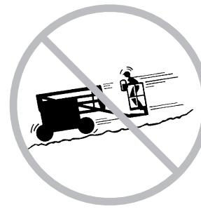
地面の状態、まわりの混雑具合、傾斜、人の位置、およびその他追突の要因となるものによって、走行速度を制限してください。
