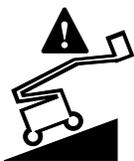
**CE モデル：**作業台が上昇しているときに傾斜アラームが鳴る場合には、機械の非水平表示ランプが点灯し、一方向または両方向への走行機能は作動しません。斜面上におけるブームの状態が、以下のどれに当てはまるかを判断してください。安定した固い水平な地面に移動する前に、手順に従ってブームを下げてください。作業台の下降中は、ブームを旋回しないでください。
