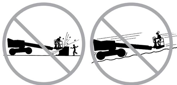
路面の状態、交通量、傾斜、人の位置、およびその他追突の要因となるものに従って、走行速度を制限してください。
