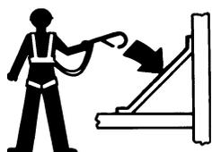
作業員は安全ベルトやハーネスを着用し、適用される法規に従わなければなりません。荷締めを作業台の錨に取り付けてください。
