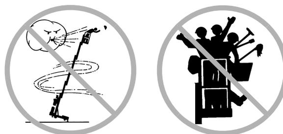
作業員、装備、および機材の重量は、作業台最大積載荷重量を超えてはなりません。
