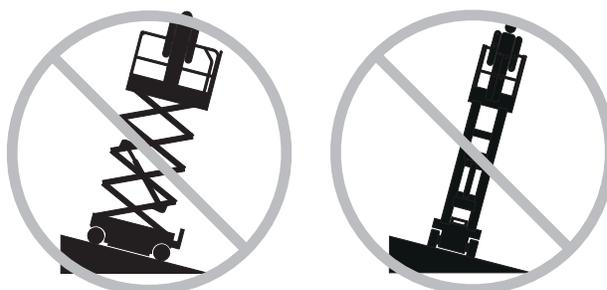
傾斜レベルの指標として傾斜アラームに依存しないでください。傾斜アラームは、機械が斜面上にある場合にのみシャーシ内で鳴ります。
